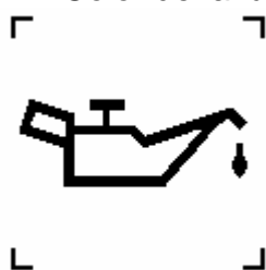
Figura 10 Presión del aceite del motor ISO 2575 n° 4.17 Color de la luz testigo: rojo
